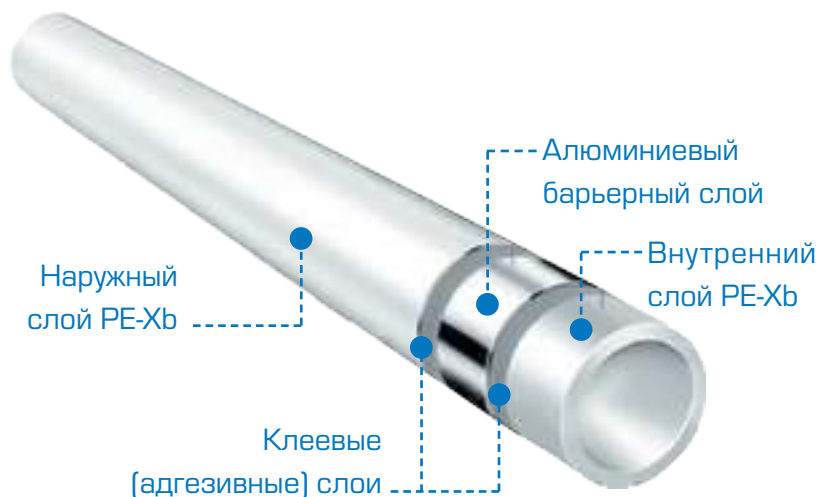
Рис. 5. Пятислойная металлополимерная труба PE-Xb/Al/PE-Xb
